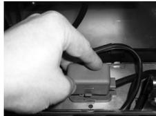
Abbildung 26 Anschlussbox schließen..
