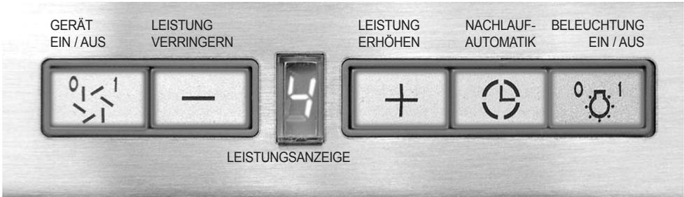
Abb. 2: Bedienfeld elektronische Steuerung
