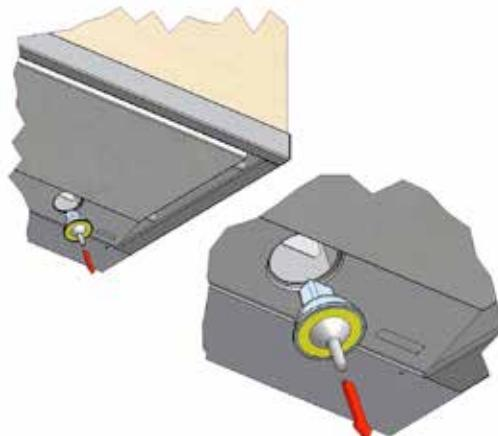
Les hottes 661 et 662 sont équipées de 2 lampes halogènes du type 12V/20W/ 35/GU4/38°, les hottes 691 et 692 sont équipées de 4 lampes du même type.
