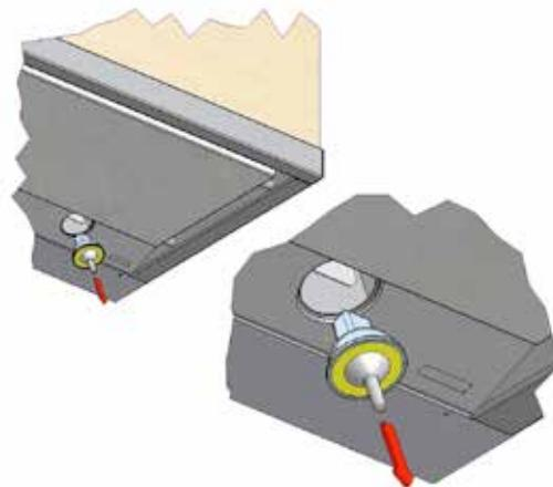
De dampkappen 661 en 662 zijn voorzien van 2 lampen van het type 12V/20W/ 35/GU4/38°, modellen 691 en 692 zijn voorzien van 4 lampen van hetzelfde type.
