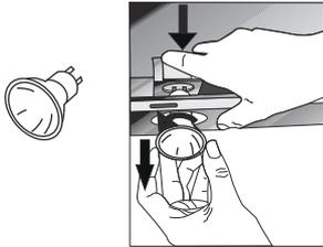
Abb. 19: LED Lampenwechsel
