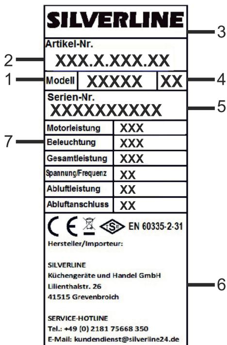
Das Typenschild befindet sich im Haubenkörper hinter den Metallfettfiltern und beinhaltet die unten genannten Informationen:
