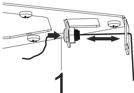
**7.** Um sicherzustellen, dass die Dunstabzugshaube parallel zum Kochfeld steht, schieben Sie das Ventil in den Hängeseilverbindungsmechanismus, den Sie einstellen werden, in Pfeilrichtung. Dadurch wird das Aufhängeseil gelockert. Bewegen Sie das Aufhängeseil in Pfeilrichtung, sodass die Haube parallel zum Kochfeld verläuft ( Abb. 12 ).
